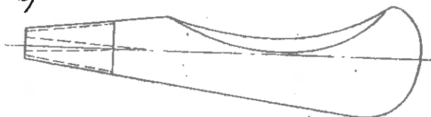
Rys. 36. Szydła i trzonki: a) szydła, b) trzonek fajkowy
